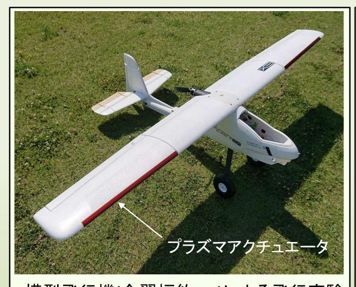
模型飛行機(全翼幅約2m)による飛行実験
