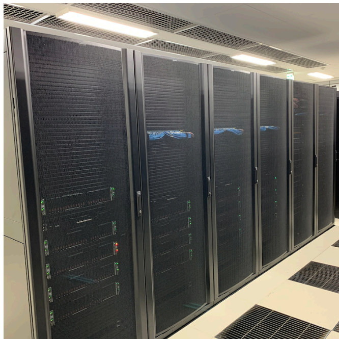
図2 サブシステム AOBA-B (4 ラック)
