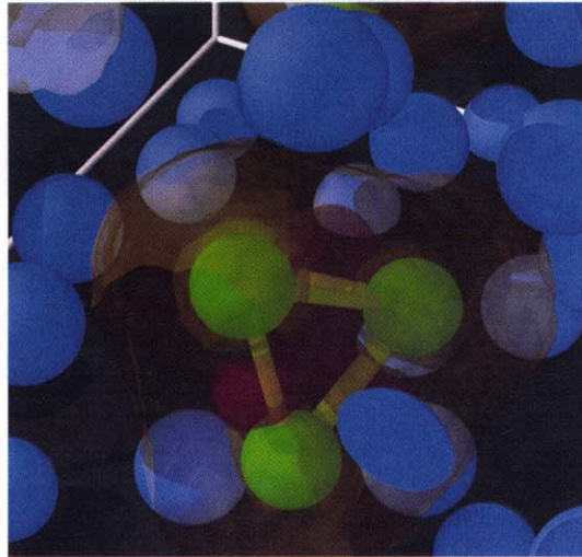
図8: Zintl イオン形成時における価電子密度分布。赤、緑の等密度面で囲まれた領域は価電子が増加した領域を示している。Zintl イオンのまわりでは電子が増え、特に Zintl イオン内の Pb 原子間で高い電子密度を示している。一方でアルカリ金属の周りでは電子が減少していることがわかる。
