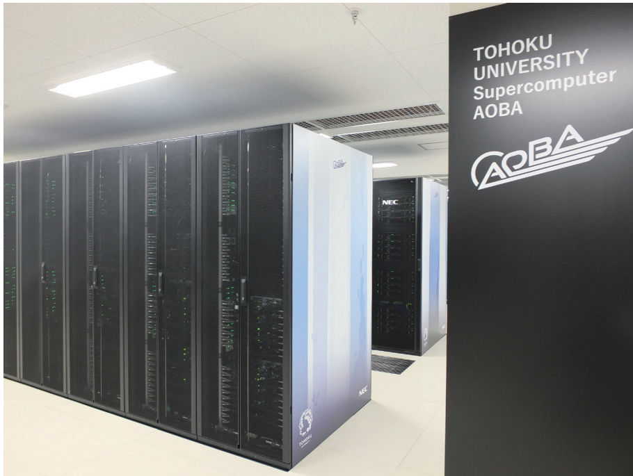
図2 サブシステム AOBA-S (32 ラック)
