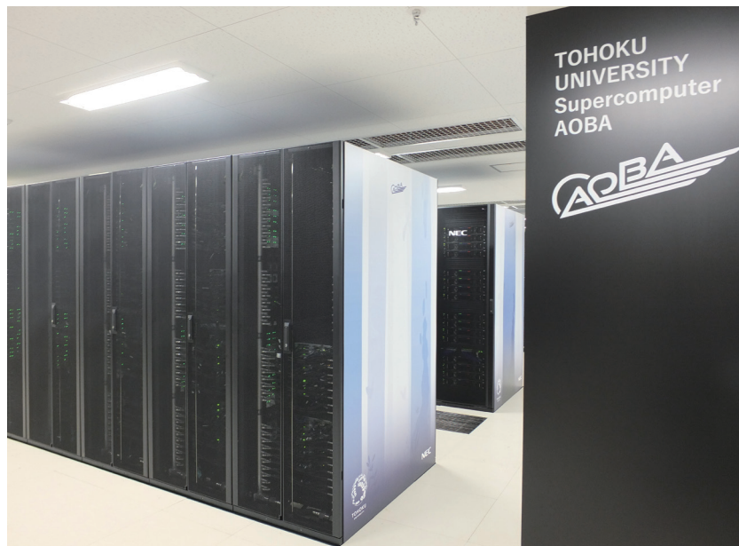
図2 サブシステム AOBA-S (32 ラック)
