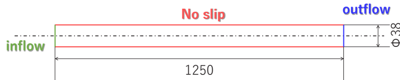
図 3 熱分解シミュレーションの解析対象
