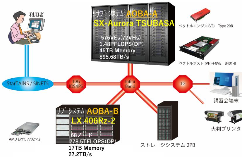
図1 スーパーコンピュータ AOBA 構成図
