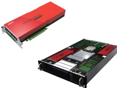
図2 サブシステム AOBA-A(VEとB401-8)
