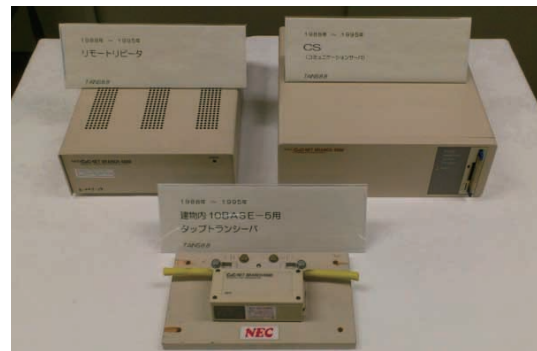
写真2 リモートリピータ、CS、タップトランシーバ
