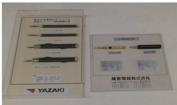
写真3 FDDI 光ファイバケーブルと同軸ケーブル
