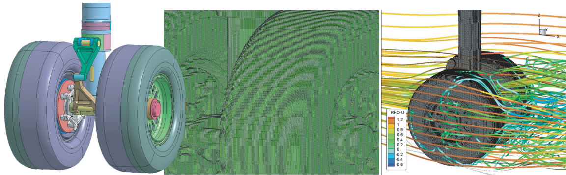
図3. 航空機脚周りの流れの計算例
