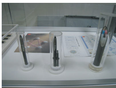
写真 9. SuperTAINS に使用した 光ファイバーのカットモデル
