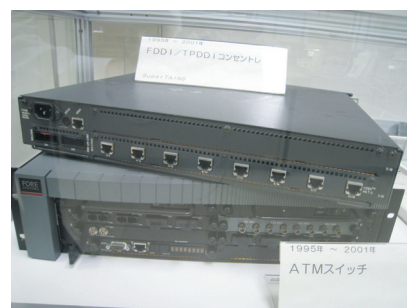
写真 10. ATM スイッチと FDDI/TPDDI コンセントレータ
