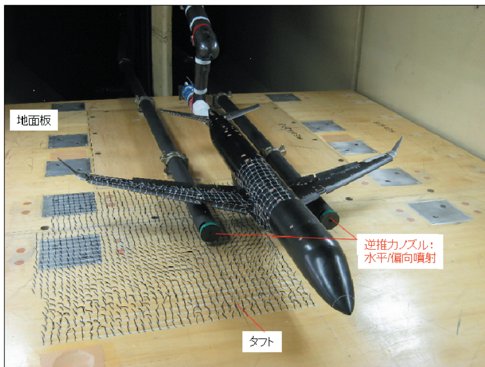
図 11 スラストリバーサ機体干渉検討用簡易低速風洞試験 (MHI 2m 低速風洞)
