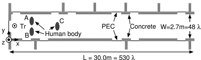
図 1: FDTD 法による室内 UWB パルス伝搬の解析モデル
