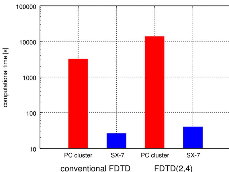
図 8: スーパーコンピュータと PC クラスタによる FDTD 並列計算の計算時間の比較
