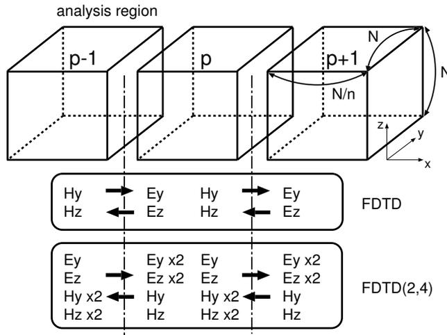
図 6: FDTD 法の並列計算における計算機間の電磁界の送受信
