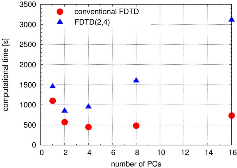
図 7: PC クラスタにおける FDTD 法および FDTD(2,4) 法の並列計算の計算時間
