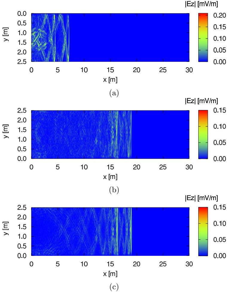
図 2: FDTD 法による室内廊下における UWB パルスの伝搬解析 ( $|E_z|$  の空間分布) (a) 20 ns 後 (b) 60 ns 後 (c) 60 ns 後 (人体なし)
