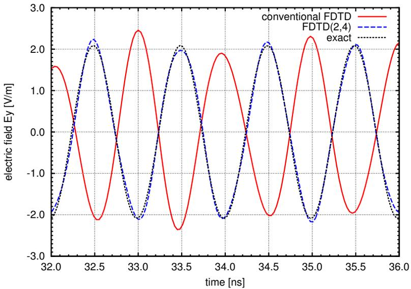
図 5: 伝搬距離  $30\lambda$  で生じる数値分散誤差の実際 ( $\Delta s = \lambda/10$ )
