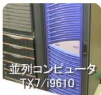
並列コンピュータ TX7/i9610の1つのノードは、Intel最新の64ビットプロセッサItanium2™(IA-64)を64台と512GBの主記憶装置を搭載しています。1CPUあたり6.4GFLOPSの計算能力を有しますので、ノードあたりの最大演算性能は409.6GFLOPSとなります。ベクトル演算に不向きなプログラム的高速な実行が可能です。また、スーパーコンピュータSX-7およびSX-7Cのフロントエンドサーバとしての役割も担っております。
