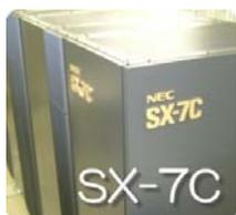
スーパーコンピュータ SX-7C は5つのノードで構成され、それぞれのノードは16GFLOPSのベクトルプロセッサ8台と128GBの主記憶装置を搭載しています。5つのノードで最大640GFLOPS、メモリ容量640GBの大規模かつ高性能な処理が可能になります。並列処理にはMPIを使った並列プログラミングが必要になります。
